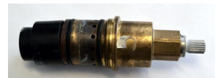
Figure 3 Valve thermostatique défectueuse.
