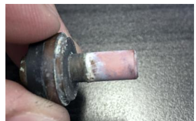
Figure 4 Piston saisi dans le calcaire avant l'installation du catalyseur Mag-O-Pure
