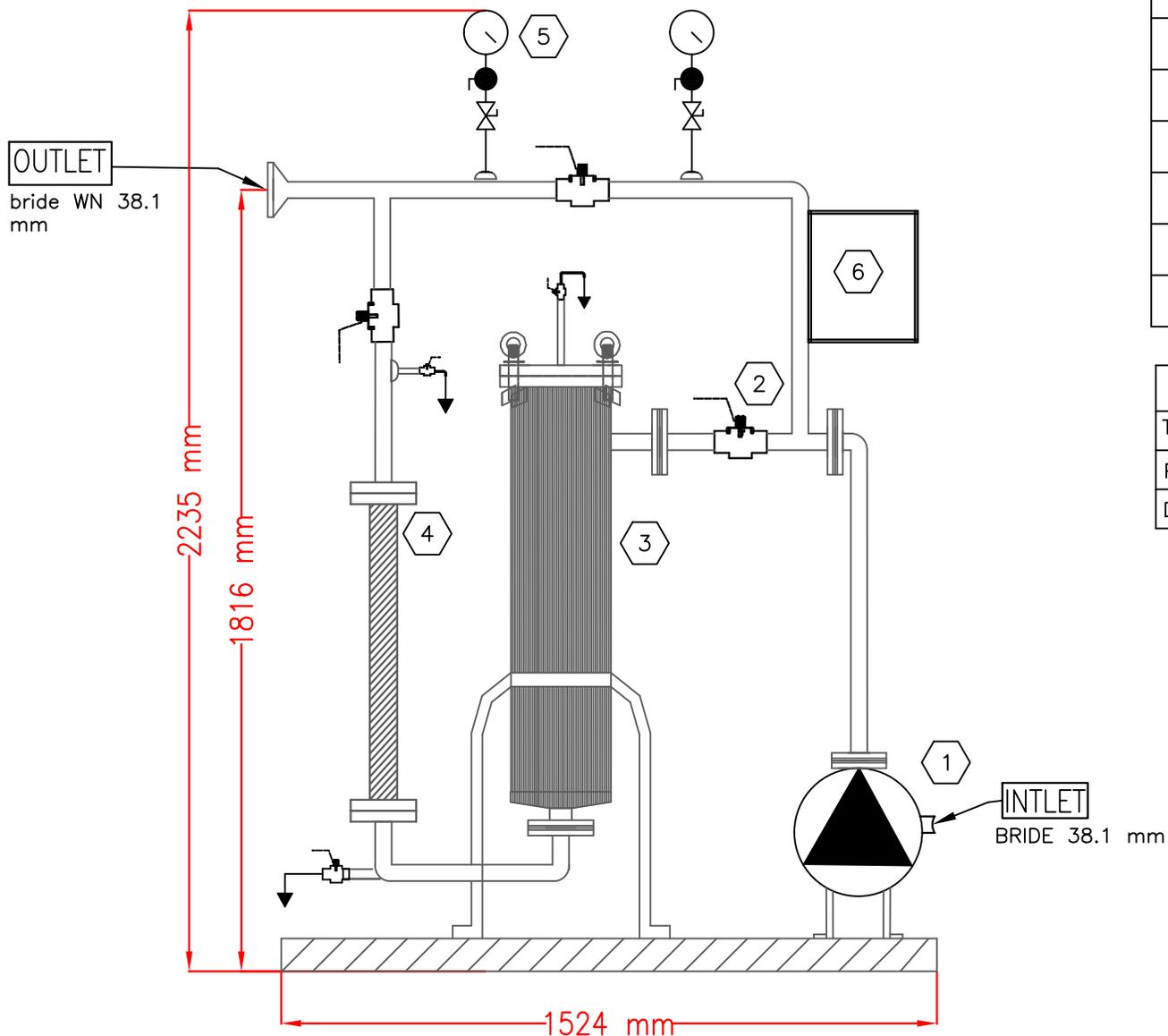
P.S: Tous les tuyaux sont en acier inoxydable d'un diamètre de 38.1 mm.
