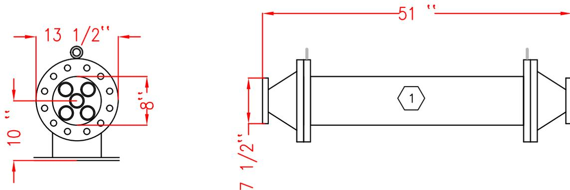
P.S. La hauteur du centre du catalyseur peut être ajustée selon la hauteur du support et la longueur totale du catalyseur peut varier de + ou - 1".
